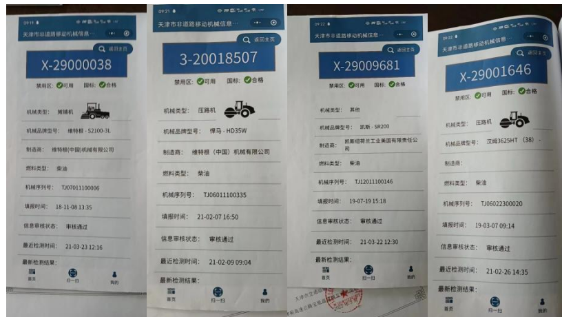
图 7-1 施工机械定期检验合格标志
