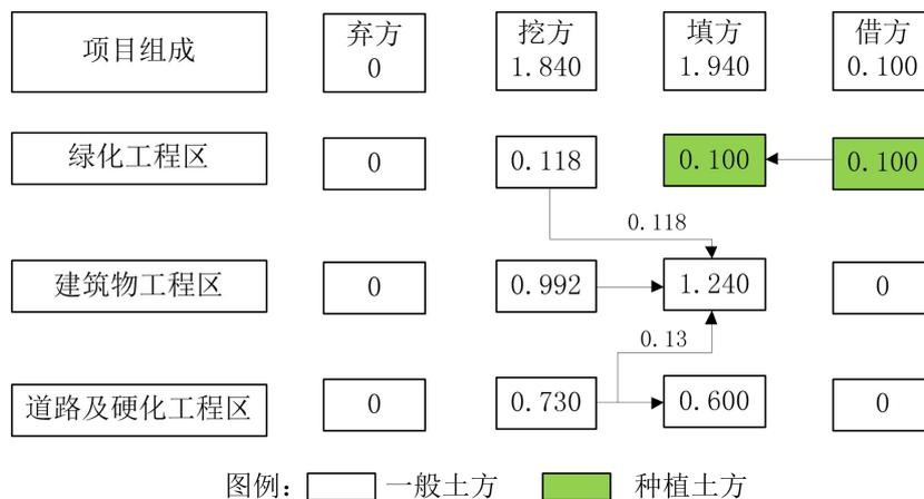
图 2.4-1 土石方平衡及流向图（单位：万 m<sup>3</sup>）
