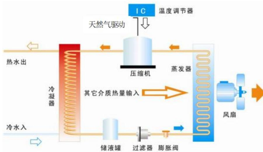
图 2-3 燃气空气源热吸收式泵工作原理图
