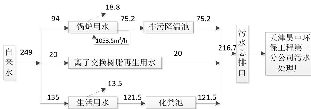
图 2-1 煤改燃后全厂水平衡图 (单位:  $\text{m}^3/\text{a}$ )
