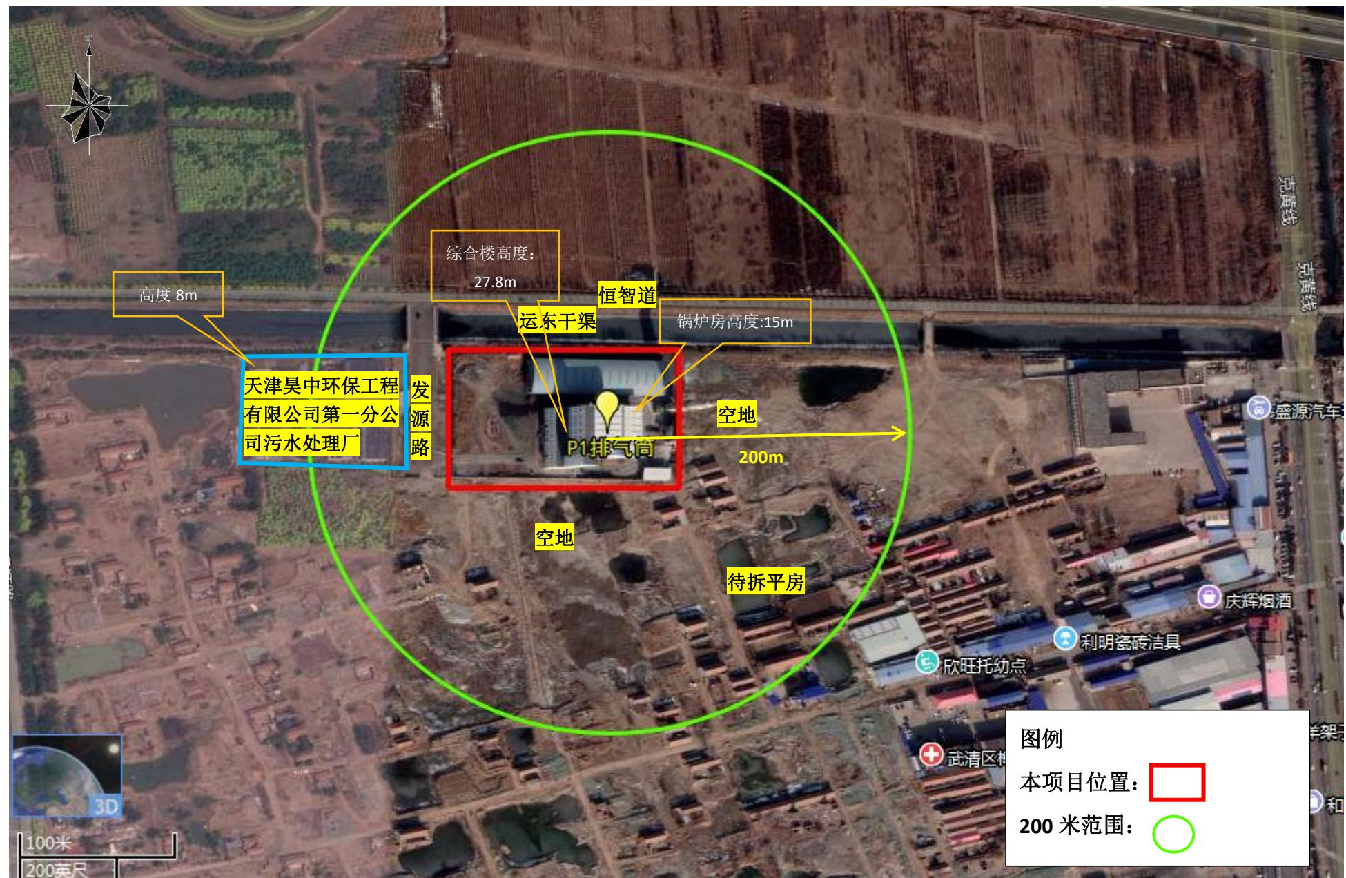
附图 2 本项目周边关系及排气筒 200m 范围内建筑物高度图
