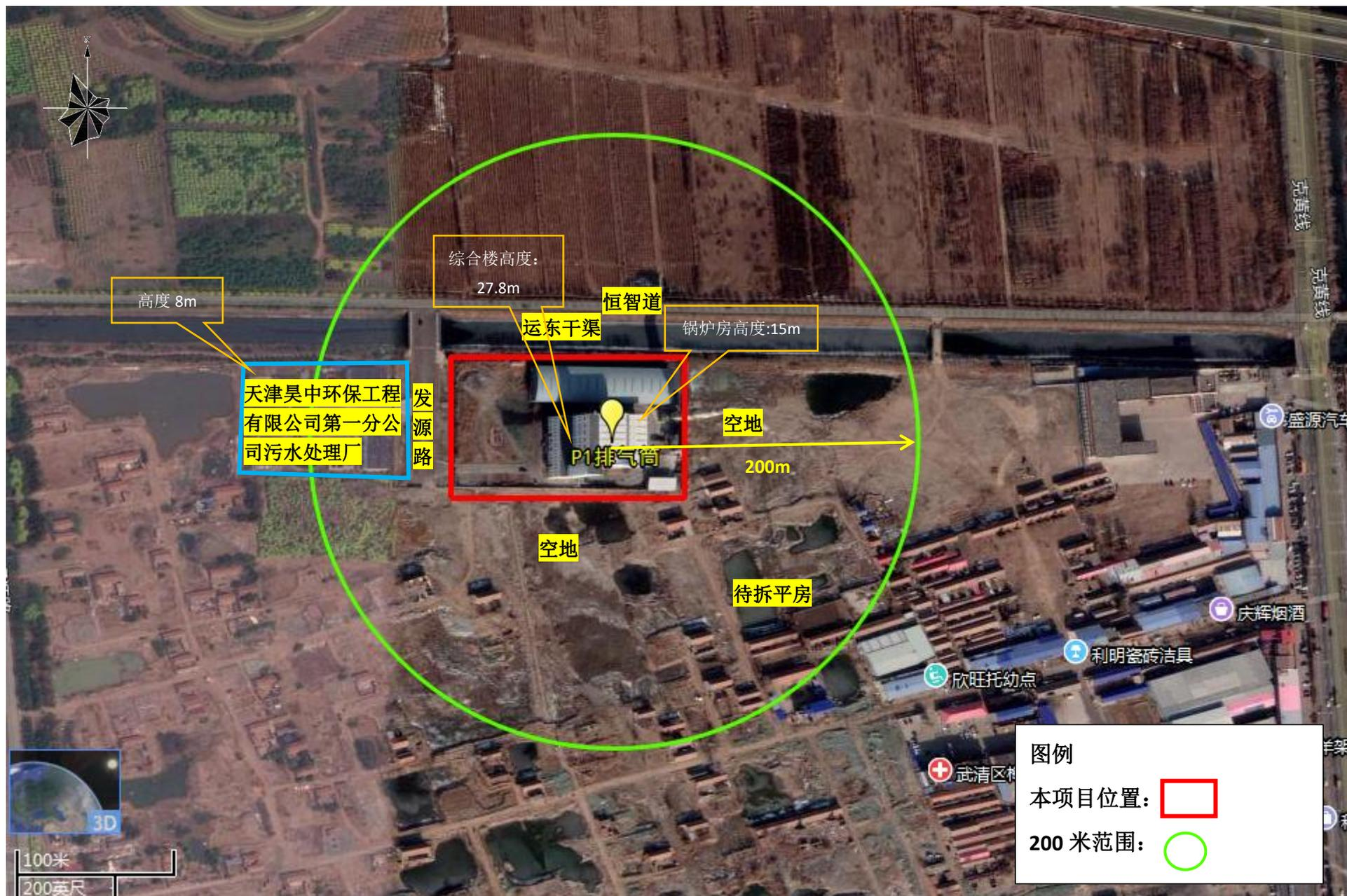
附图 2 本项目周边关系及排气筒 200m 范围内建筑物高度图
