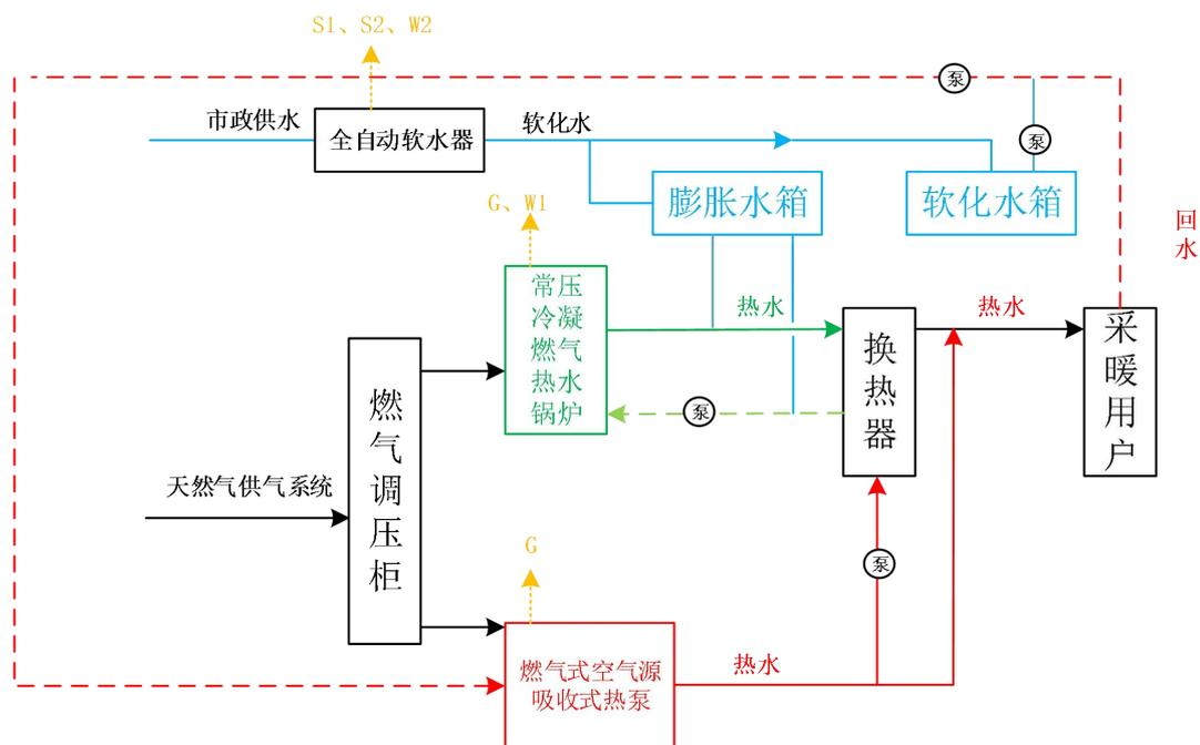
注：G 燃气废气、S1 废包装材料、S2 废离子交换树脂、W1 锅炉排浓水、W2 离子交换树脂反冲洗废水
