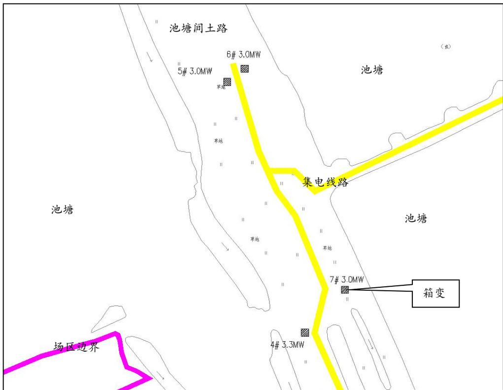
图 2-4 箱式变压器位置示意图 (局部放大显示)
