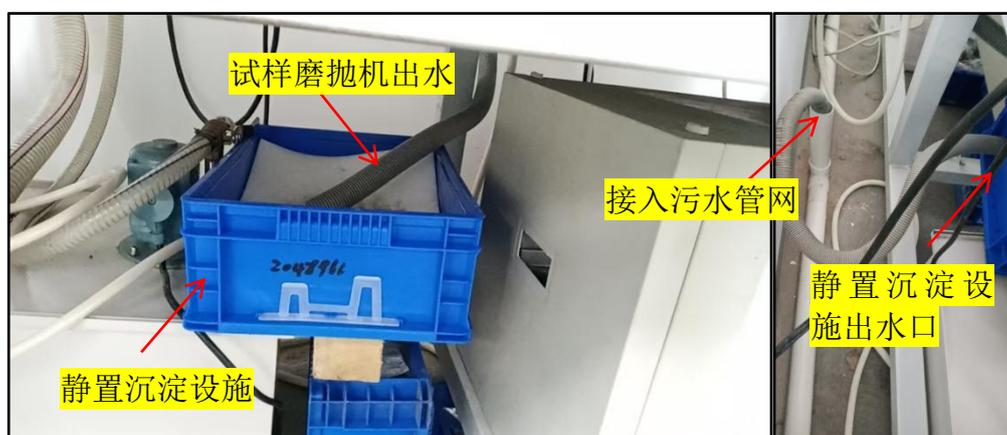
图 3-2 试样磨抛机的小型静置沉淀设施
