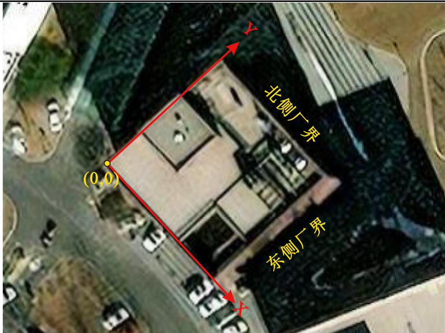
图 4-1 噪声预测 X、Y 轴及原点设置情况
