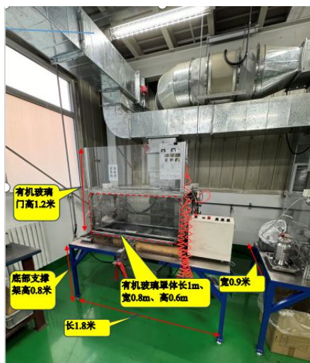
图 2-1 本项目新增喷涂设备尺寸及结构图
