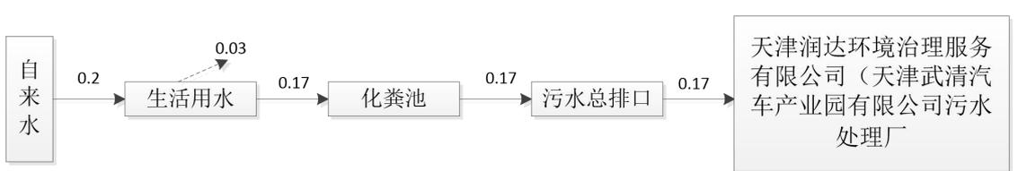
图2-4 扩建后全厂非采暖期水平衡图 (单位:  $\text{m}^3/\text{d}$ )
