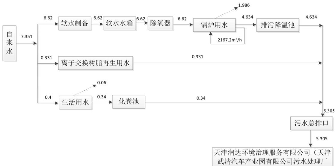
图2-3 扩建后全厂采暖期水平衡图 (单位: m<sup>3</sup>/d)
