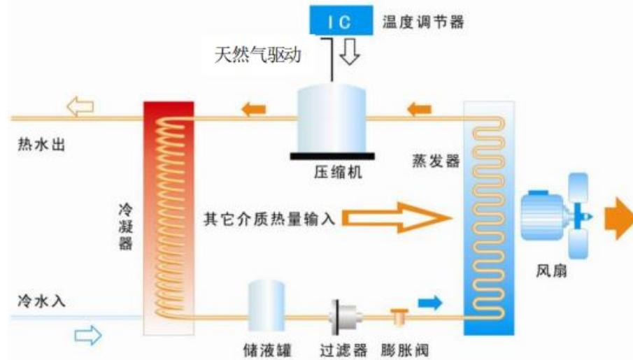
图2-6 燃气空气源吸收式热泵工作原理图
