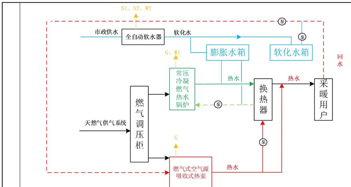
注：G 燃气废气、S1 废包装材料、S2 废离子交换树脂、W1 锅炉排浓水、W2 离子交换树脂反冲洗废水
