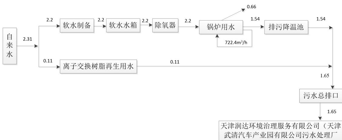
图2-2 本项目采暖期水平衡图 (单位: m<sup>3</sup>/d)
