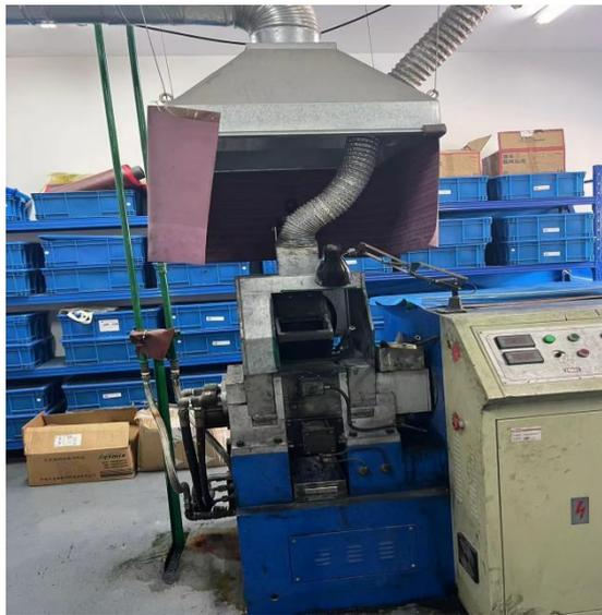
密炼机及废气收集方式
