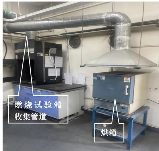
燃烧试验箱、烘箱及废气收集方式
