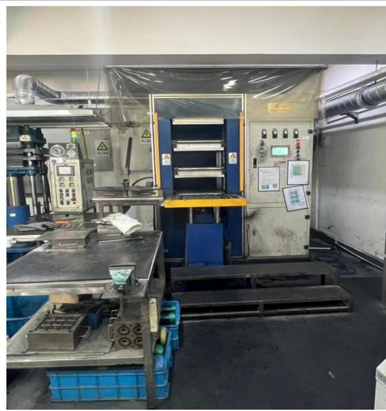
硫化机及废气收集方式
