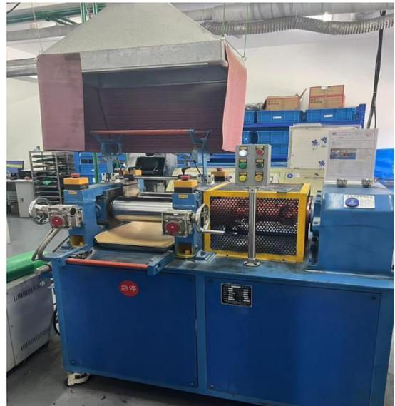
开炼机及废气收集方式
