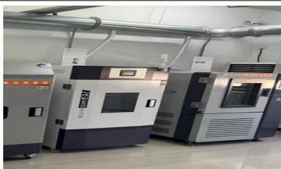
老化实验室废气密闭收集管道
