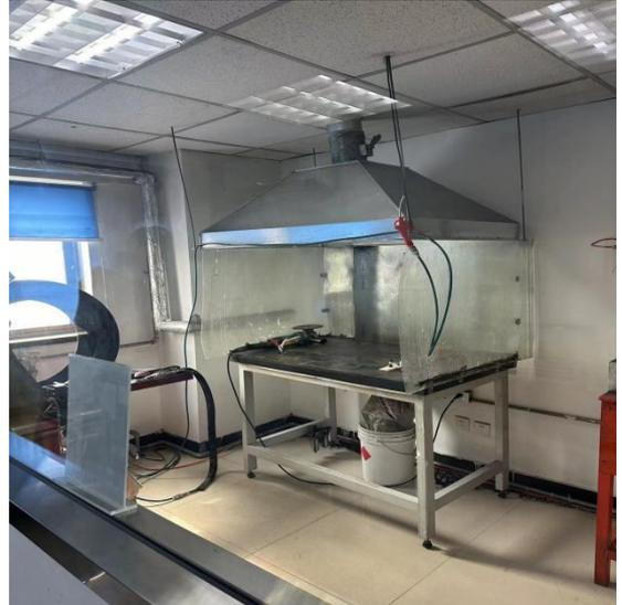
剥离实验室打磨实验及废气收集方式
