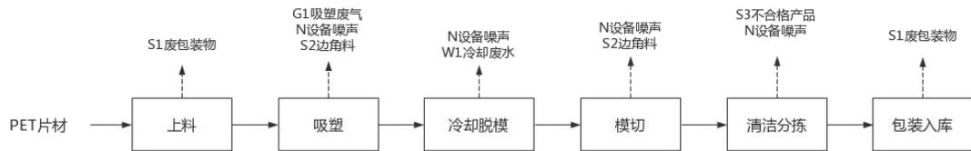
图 2-2 生产工艺及产排污环节示意图
