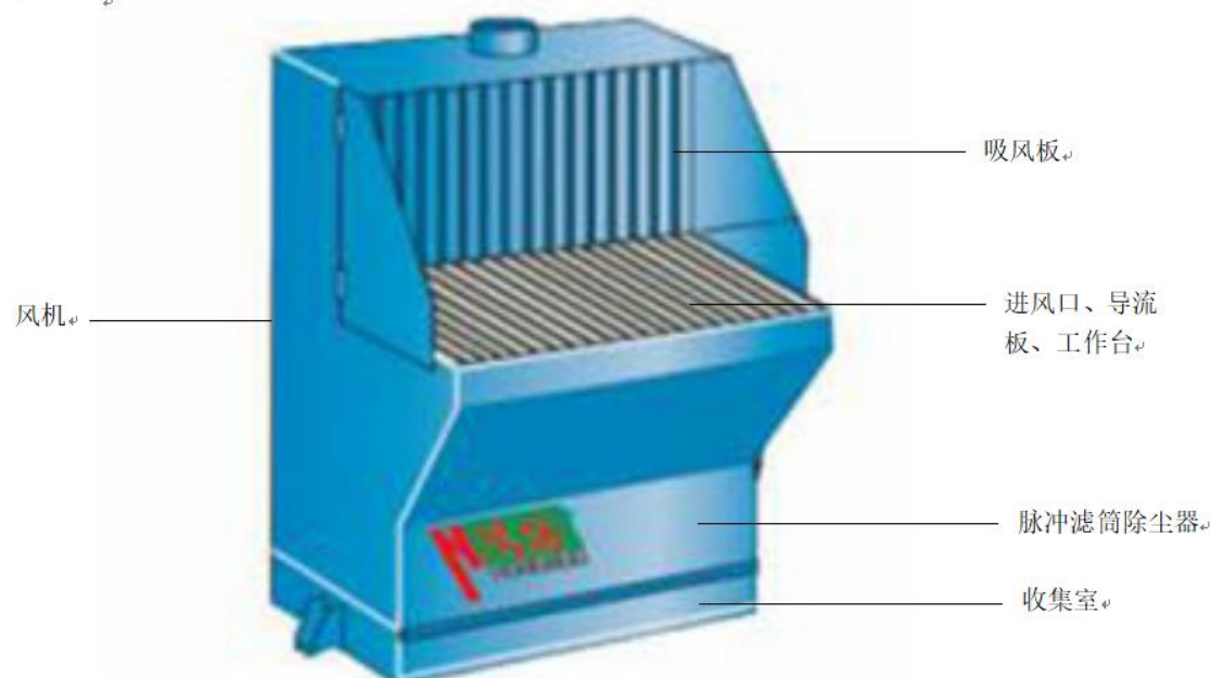
图 4-1 打磨柜示意图
