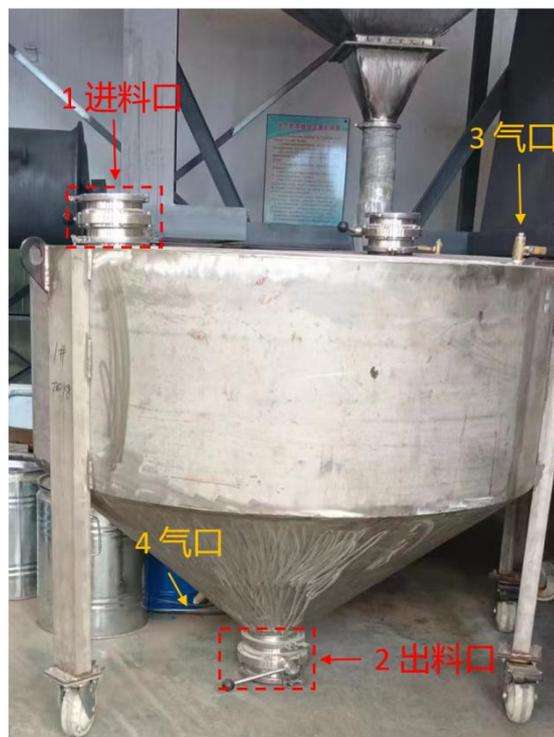
图 2-4 储料罐的结构
