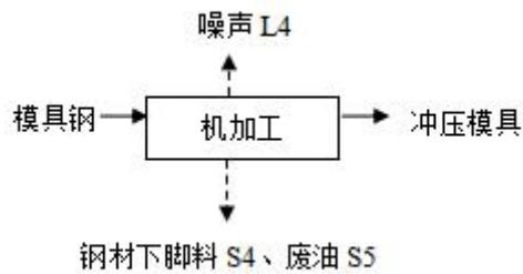
图 4 冲压模具生产工艺流程及产污节点图
