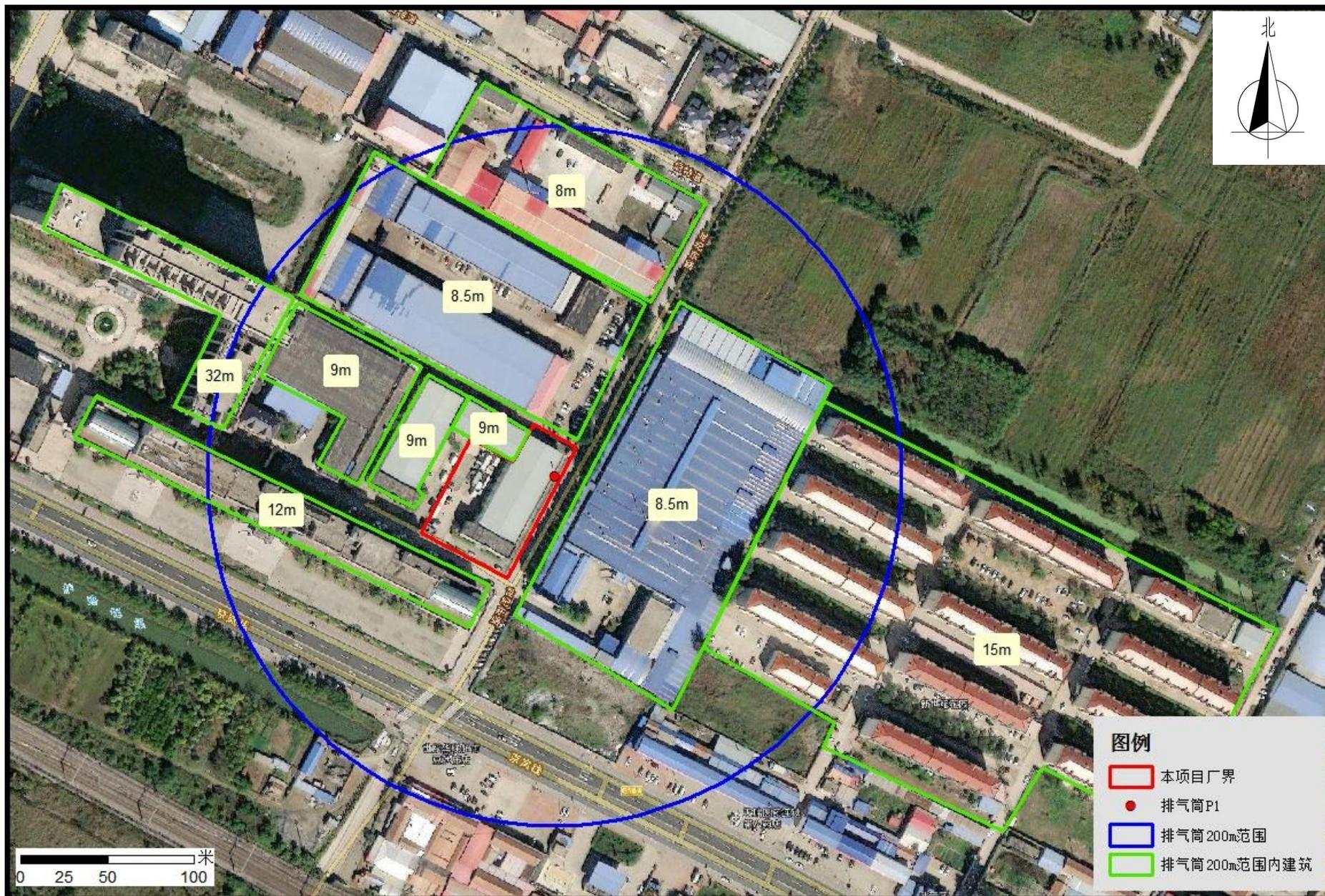
附图 13 本项目排气筒 200 米范围内建筑高度图
