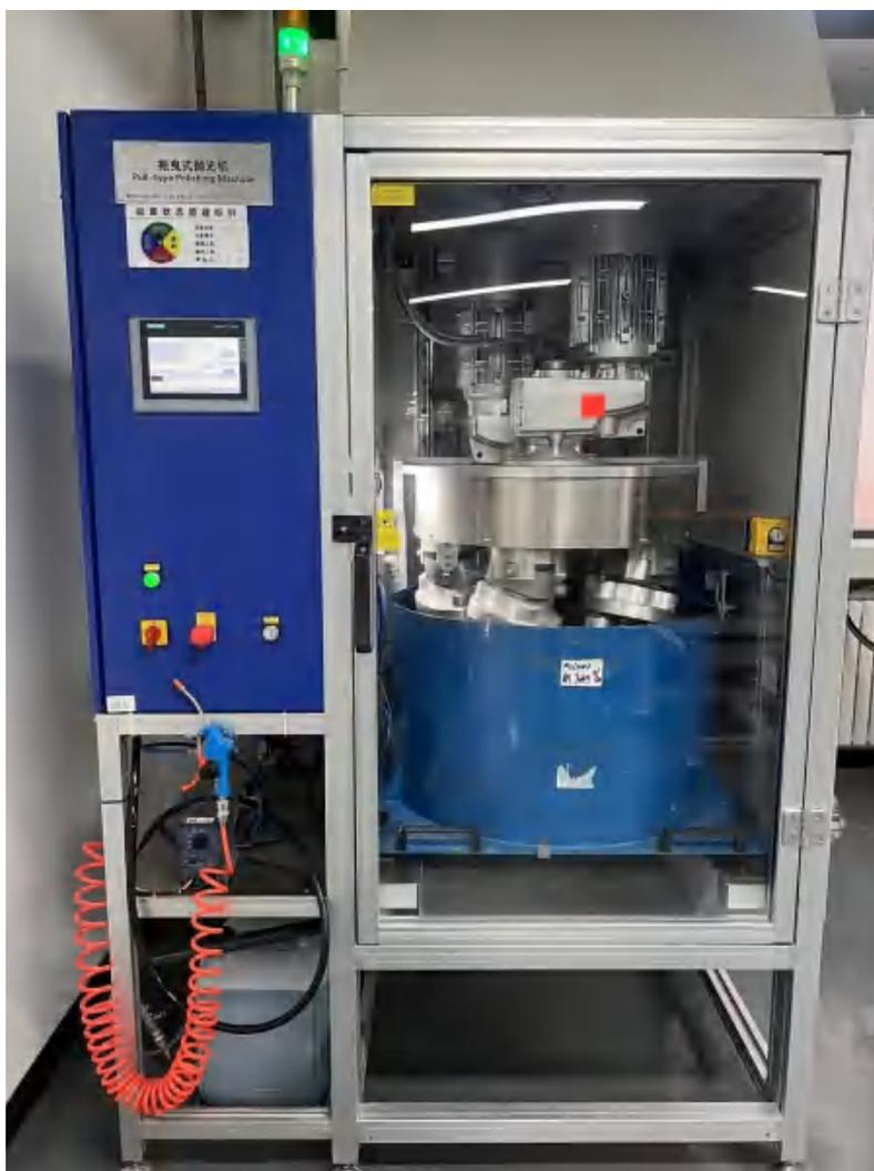
图 2-6 拖曳式抛光机设备图
