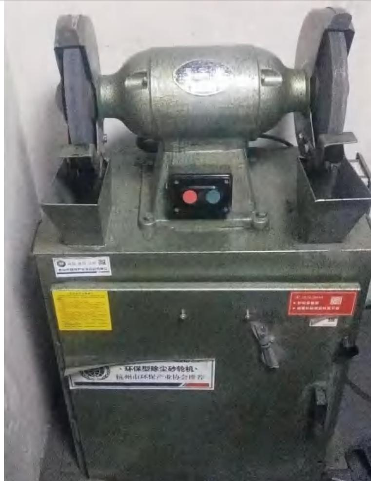
图 2-1 环保型砂轮机设备图
