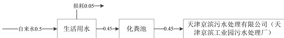
图2 本项目水平衡图（单位：m 3 /d）
