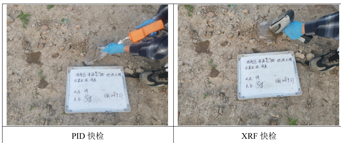
图 4.2-2 现场快速检测照片
