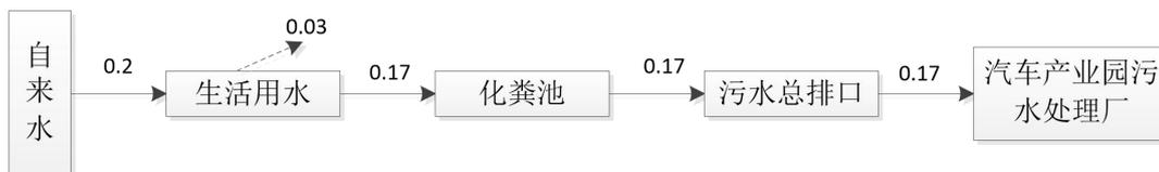
图2-4 扩建后全厂非采暖期水平衡图 (单位: m<sup>3</sup>/d)
