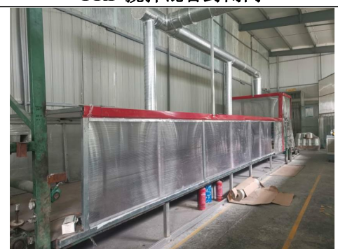
FRP 加温固化工序密闭收集
