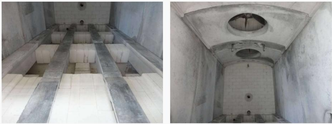
图 2-4 多用炉内部加热室设备图
