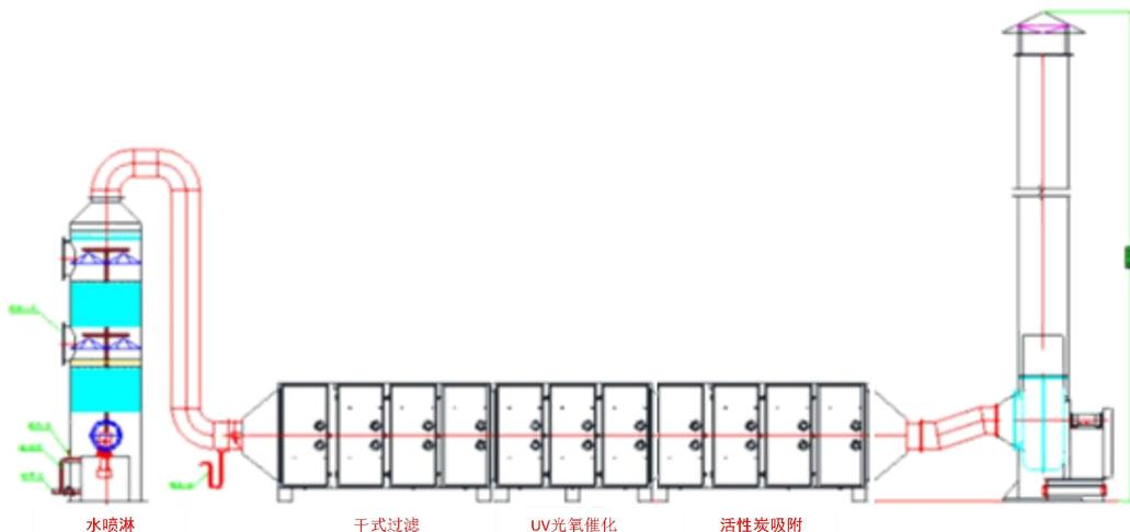
图 4-1 废气处理设施组成示意图
